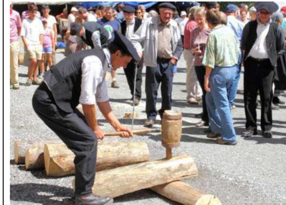
Un coin de fendage est un morceau d'acier en forme de triangle utilisé pour diviser les grandes sections de bois. Il est frappé avec un maul (masse en bois).
