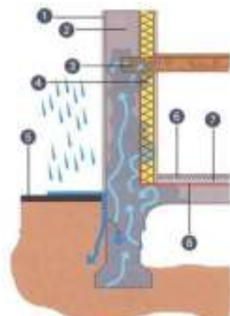
ACTION D'UN ENDUIT ÉTANCHE DÉGRADATION DU PAREMENT ET DES MURS
